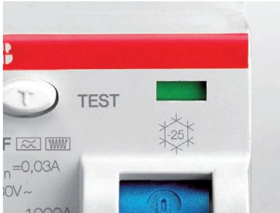
Gli interruttori differenziali F200 possono essere usati con temperatura compresa tra -25°C (fiocco di neve impresso a laser sul fronte del dispositivo) e +55°C.
