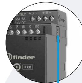
Connessione tramite porta ausiliaria AUX
