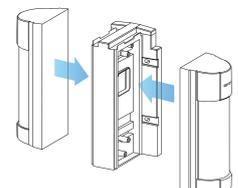
Avvertimento: la squadretta VXI-T non può essere usata per una combinazione di due rivelatori a microonde DAM-DAM, DAM-RDAM, RDAM-RDAM.
